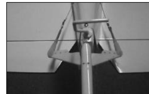
FIGURA 4 – instalação do trem de pouso
