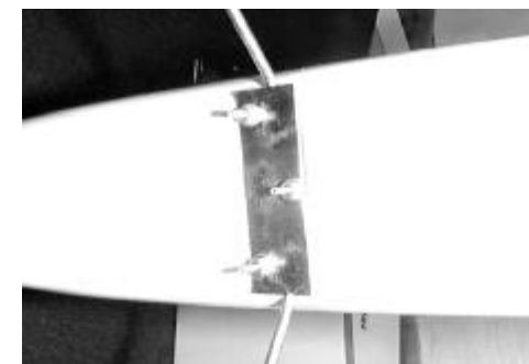
FIGUA 4 – instalação do trem de pouso
