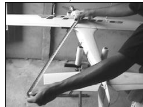
FIGURA 4 – instalação do trem de pouso
