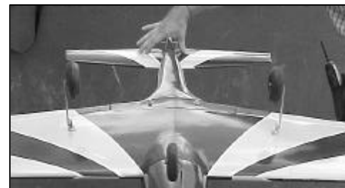
FIGURA 1 – instalação do estabilizador
